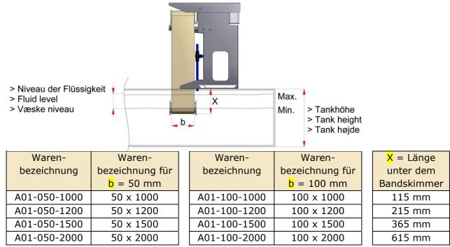
(Beispiel: 50 x 1000: Bandbreite 50 mm, Bandlänge (Umfang) 1000 mm und das Band reicht 115 mm unterm Bandskimmer)
