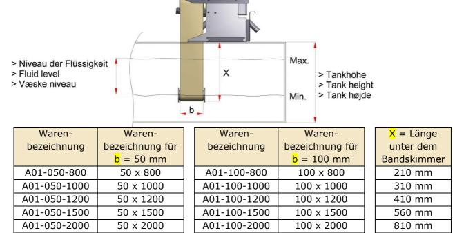
(Beispiel: 100 x 800: Bandbreite 100 mm, Bandlänge (Umfang) 800 mm und das Band reicht 210 mm unterm Bandskimmer)
